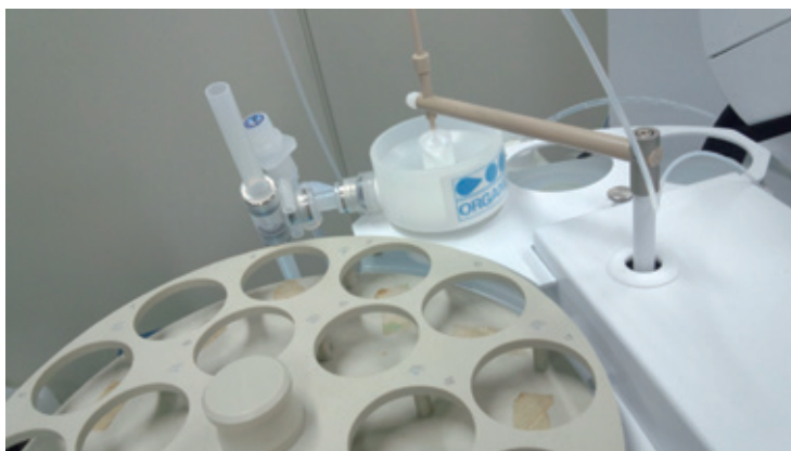
アジレント・テクノロジー製 ICP-MS に取り付けたリンスポート
