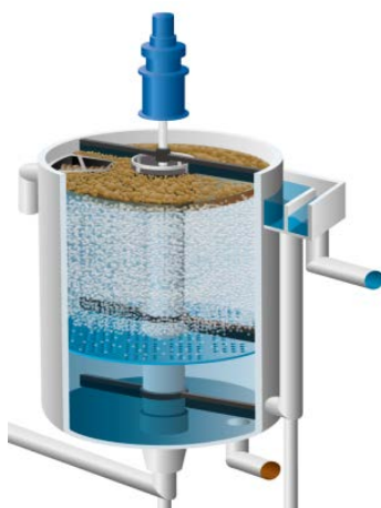
高速加圧浮上装置
