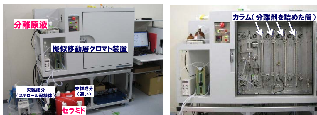
写真 1 擬似移動層クロマトグラフ装置の外観（左）と内部（右図） 分離原液から連続的に夾雑物とセラミドが分離されて出てくる
