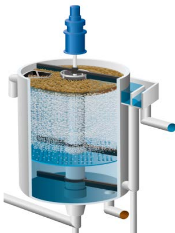
高速加圧浮上装置
