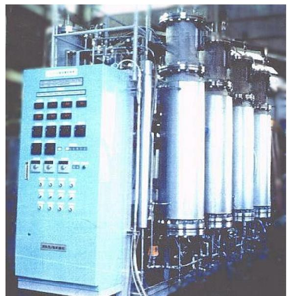
図. 5 ラクチュロース精製実験機
